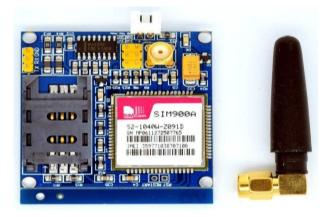
Fig. 2. SIM module (SIM900).
